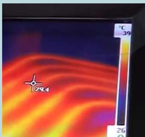
Найти утечку в теплом полу можно с помощью тепловизора с хорошей чувствительностью
